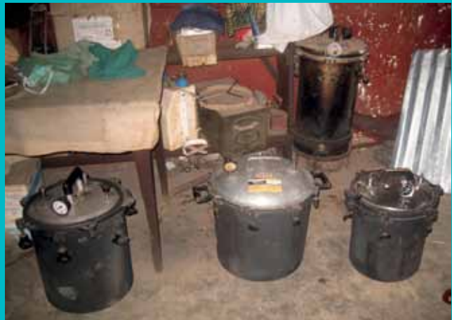
In afwachting van de herstelling van de grote autoclaaf worden kleinere ketels gebruikt om te steriliseren.
